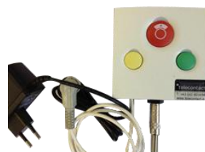
EasyControl Schwesternruf-Modul für Kabelmatten (optional für Schrack)
