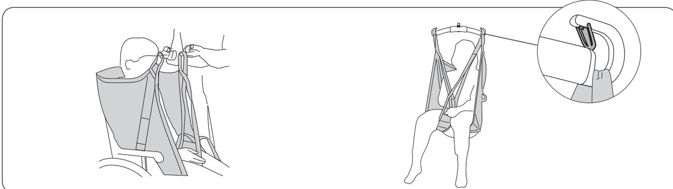
**Anmerkung:** Stellen Sie sicher, dass alle Aufhängeschlaufen gleich lang sind, d.h. sich beim Straffen vor dem Anheben auf gleicher Höhe befinden. Wenn dies nicht der Fall ist, passen Sie die Position des Hebegurts an.
