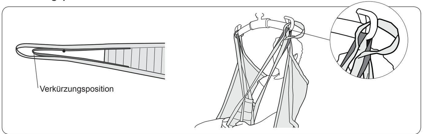
Unsere Hebegurtmodelle wurden mit Sorgfalt so konzipiert, dass gewährleistet ist, dass der Pflegebedürftige immer so sitzt, dass der Druck gleichmäßig zwischen Beinen und Rücken verteilt wird, damit eine gute Unterstützung während Transfers sichergestellt ist. In bestimmten Fällen könnte es jedoch besser sein, die innere Einstellung – die „Verkürzungsposition“ – der Beinstützenhebeschlaufen zu verwenden, um die Sitzposition des Pflegebedürftigen zu verändern.
