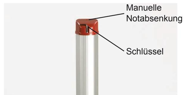
Für die manuelle Notabsenkung wird ein Schlüssel mitgeliefert (sitzt in einem Halter oben an der Säule). Den Schlüssel in die Öffnung oben an der Säule stecken und kurbeln, bis der Patient abgesenkt ist.
