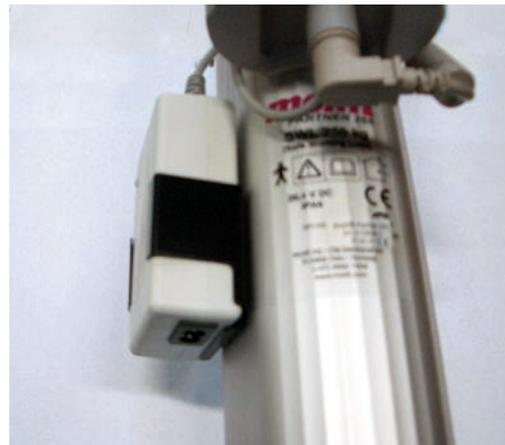
Parken Sie den Lifter und schließen Sie ihn an eine gewöhnliche Steckdose an. Der Akku wird im Ladegerät aufgeladen.
